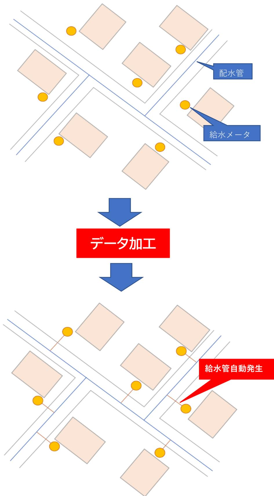
給水メータより直近の配水管へ自動で垂線を引き、給水管を自動作成致します
