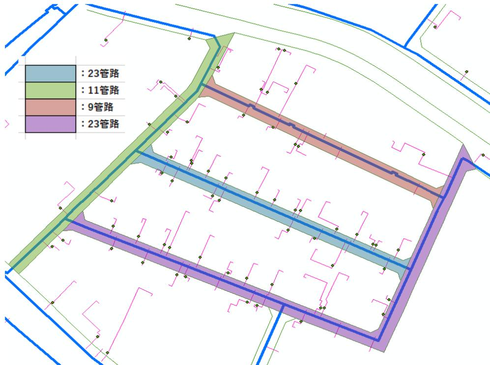
自動作成された道路ポリゴンを使い、上記の様に特定の道路ポリゴン内の配水管より分岐されている給水管数を自動算出したり、またはポリゴン内の配水管延長を自動算出すること等、様々な条件での検出・算出が可能です
